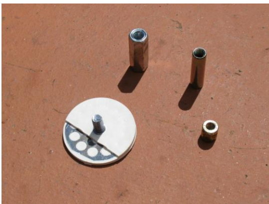
Insert-téton « échantillon » Douille de maintien (hexagonale) Douille cylindrique et morceau coupé à longueur.
